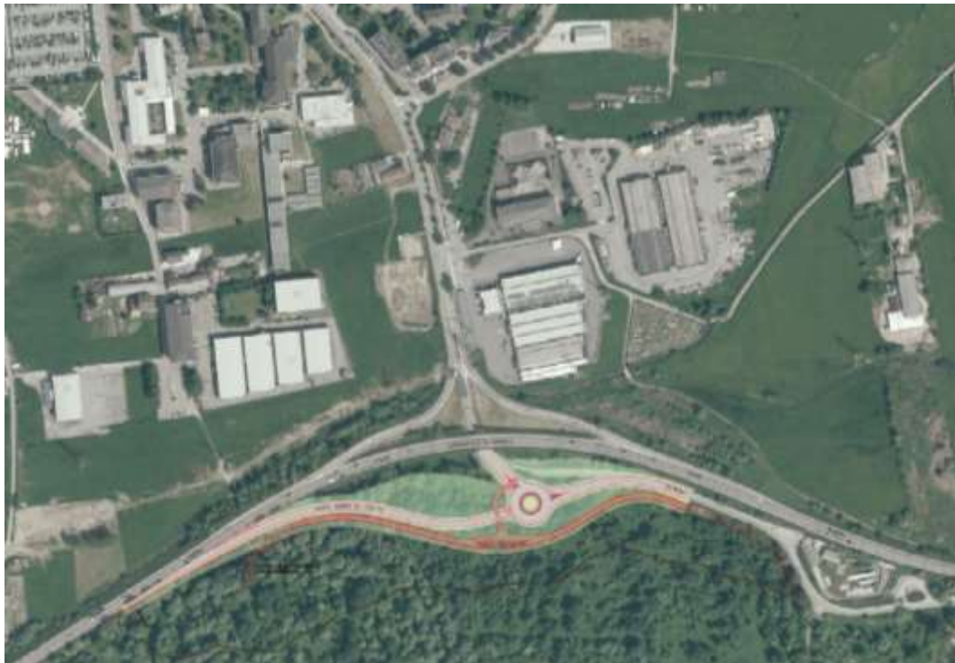
Figura 12 – Realizzazione dello svincolo tangenziale su via Samaden.
