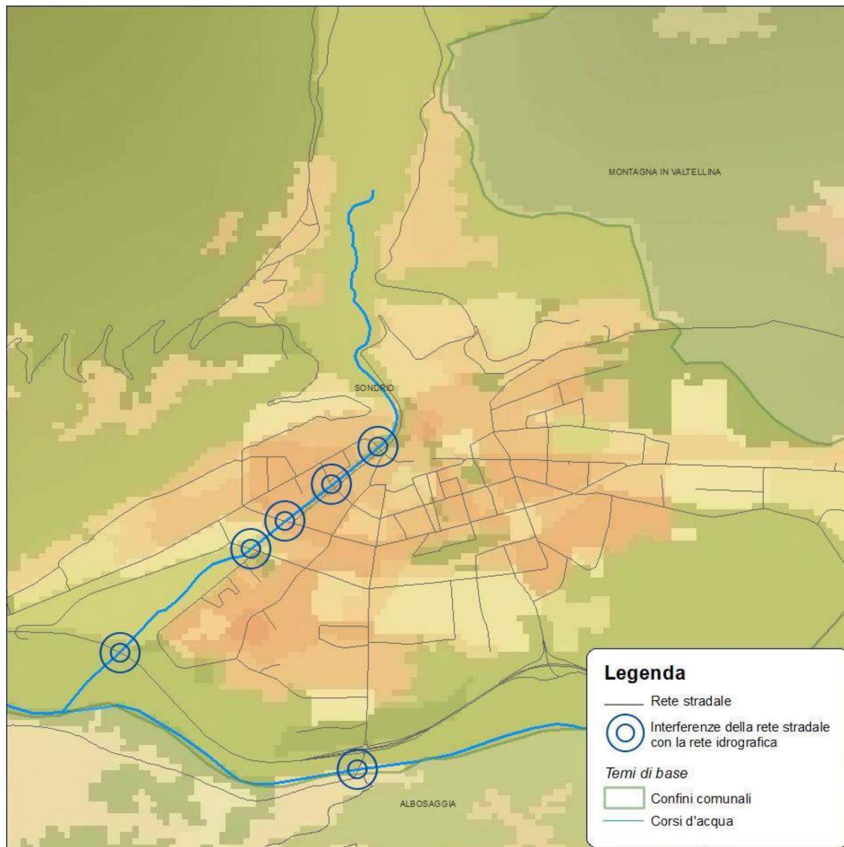
Fig. 2.6.viii – Interferenze con reticolo idrografico
