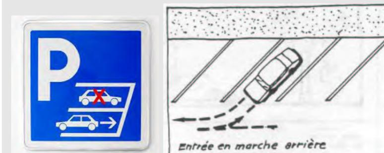
Segnaletica e schema di regolamentazione della sosta diagonale retroversa.
